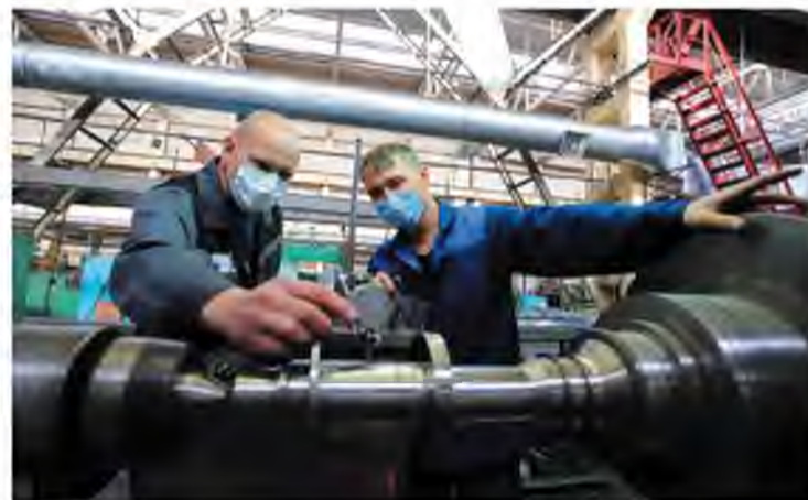
Токарная обработка ротора: токарь Иван Герасимов и мастер Максим Попов
